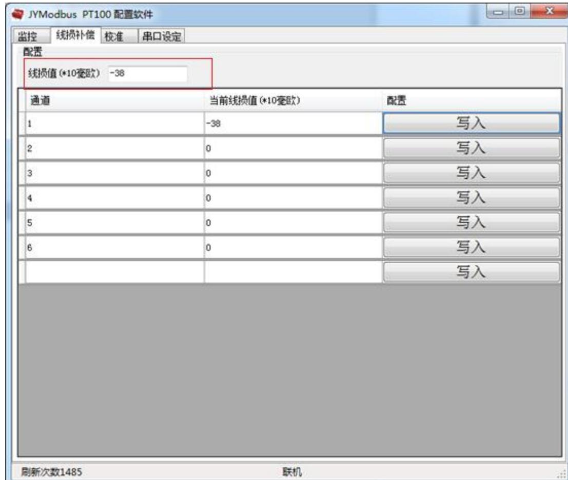
线损补偿菜单下可补偿传感器温度。线损值与温度对应关系： **380 毫欧 = 1°C**
